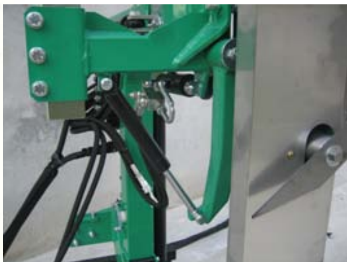
Molla antiurto di sicurezza della barra verticale
