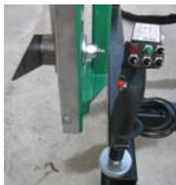
Molla antiurto di sicurezza della barra per il taglio orizzontale
